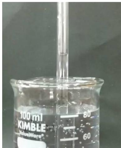
Abbildung 2: Wasser aus dem Becherglas wird durch den durch Sauerstoffverbrauch im Reagenzglas entstehenden Unterdruck im Glasrohr nach oben gezogen.
