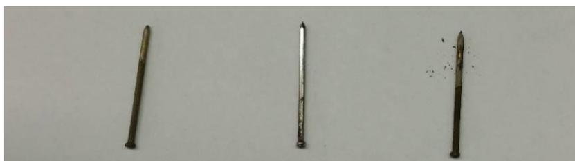
Abbildung 2: Jeweils das untere der Nägel stand in der Säure. Links: Nagel aus der Zitronensäure. Rechts: Nagel aus der Phosphorsäure mit dunkler Verfärbung. Mitte: Rostfreier Nagel zum Vergleich.
