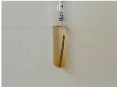
Abbildung 1: Stark korrodierter Nagel im Glas mit der Kochsalzlösung nach etwa 24 Stunden.
