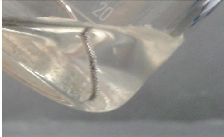
Abb. 5 - Zersetzung des Wasserstoffperoxid am Platindraht.
