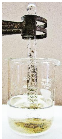
Abb. 3 – Versuchsaufbau der Bestimmung des Sauerstoffgehalts der Luft. Nach zwei Tagen ist das beigefügte Bild zu erhalten.
