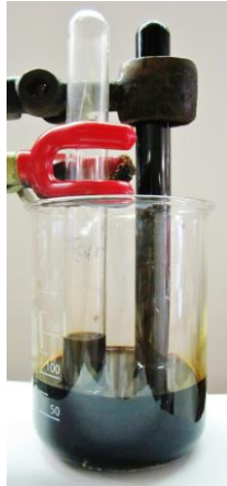
Abb. 1 – Versuchsaufbau zur Sauerstoffgehaltsbestimmung mit alkalischer Pyrogallollösung. Das Foto zeigt das Ergebnis der Reaktion.
