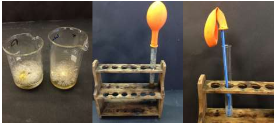
Abb. 2- Muschel und Schneckenhaus nach Zugabe von Salzsäure-Lösung (links). Reagenzglas mit einem Schneckenhaus und Salzsäure-Lösung (Mitte), Einleitung des aufgefangenen Gases in Kalkwasser (rechts).
