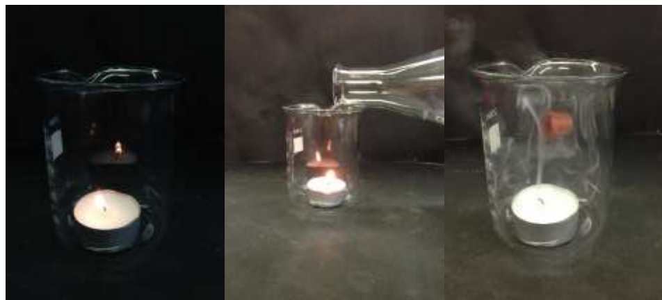
Abb. 1- Teelicht im Becherglas vor dem Hinzugießen von Kohlenstoffdioxid (links) und nach dem Hinzugießen von Kohlenstoffdioxid (rechts).
