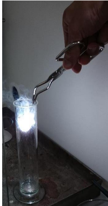
Abbildung 2: Magnesiumbrand in Kohlenstoffdioxid-Atmosphäre.
