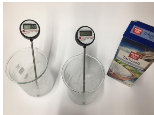
Abbildung 6: Bechergläser mit Eiswasser und Thermometer. Im rechten Becherglas ist zusätzlich Salz enthalten.
