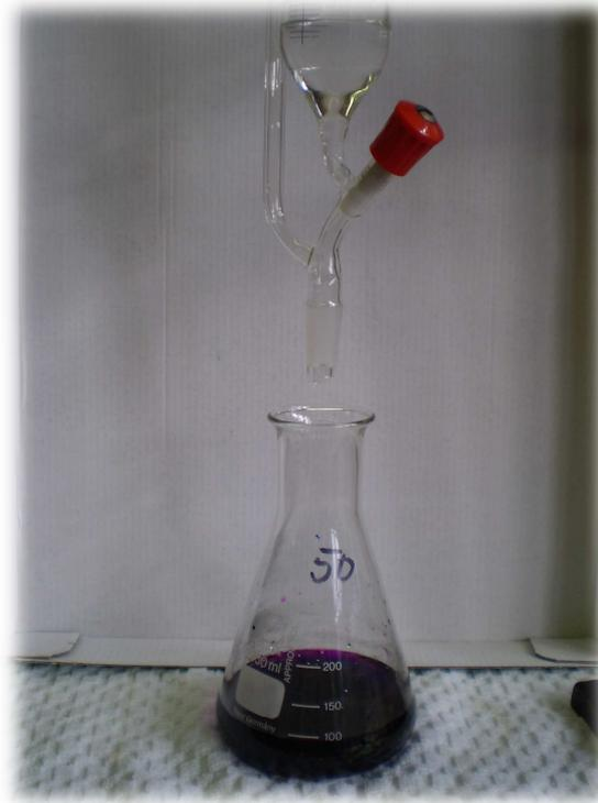
Abb. 1 - Tropfpipette mit H<sub>2</sub>O<sub>2</sub> und Erlenmeyerkolben mit KMnO<sub>4</sub>-Wasser-Lösung
