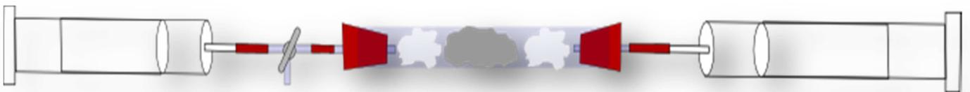
Abb. 3 - Verbrennungsrohr mit Kolbenprobern zur Bestimmung des Sauerstoffanteils in der Luft
