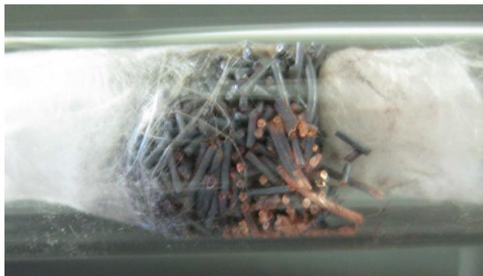
Abb. 3 - Kupfer(II)oxid Späne nach der Reaktion mit Butan.
