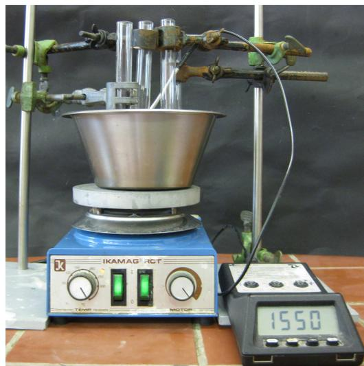
**Abb. 8 - Versuchsaufbau zur Ermittlung der Siedepunkte der Alkane.**
