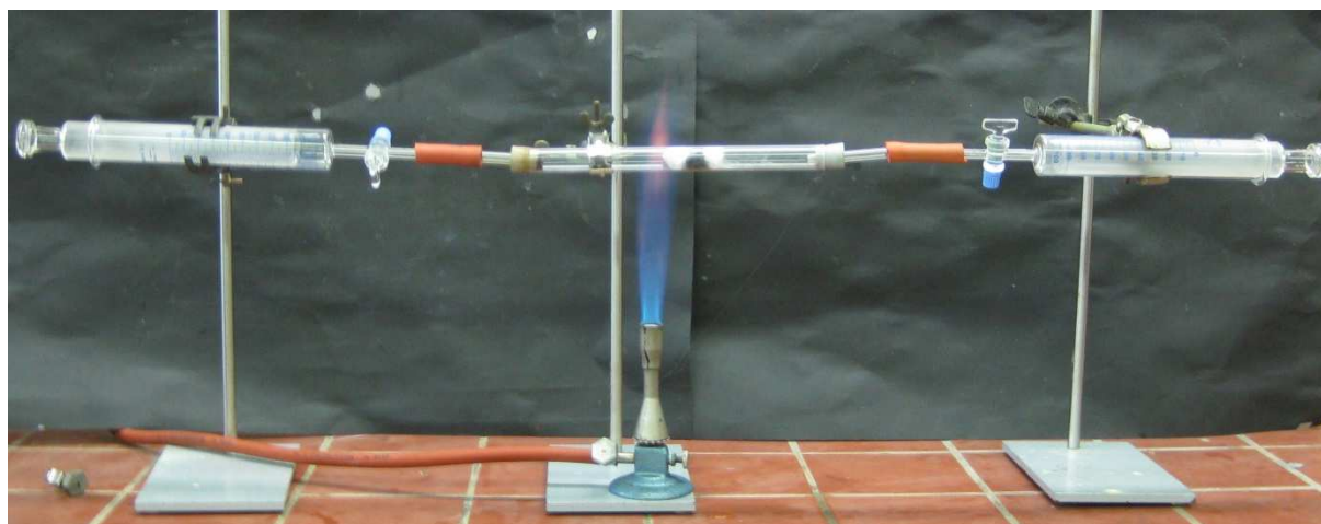
Abb. 2 - Versuchsaufbau zur Bestimmung der Anzahl der C-Atome eines Alkans.
