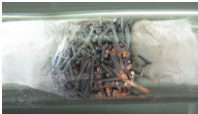
Abb. 3 - Kupfer(II)oxid Späne nach der Reaktion mit Butan.
