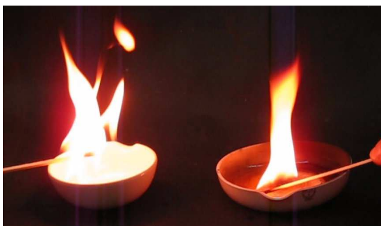
Abb. 4 - Unterschiedliche Flammpunkte von Pentan (links) und Petroleumbenzin (rechts).
