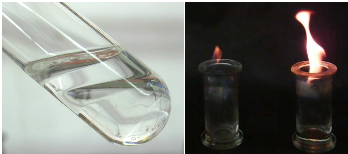
Abb. 9 – Unterschiedliche Dichten von Pentan und Paraffin (links) bzw. Methan und Butan (rechts).
