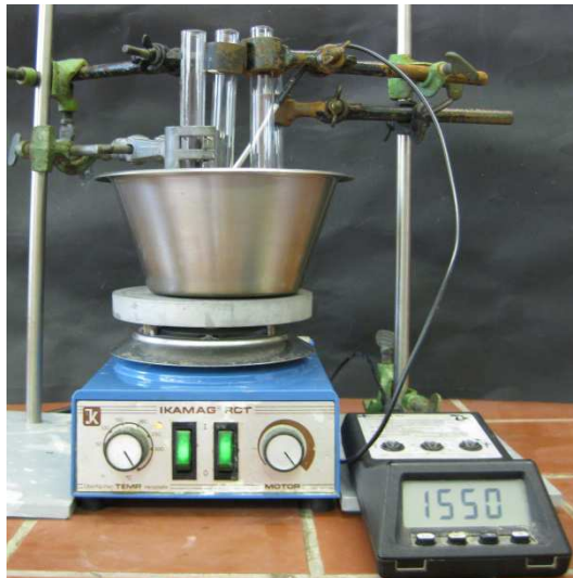
Abb. 8 - Versuchsaufbau zur Ermittlung der Siedepunkte der Alkane.
