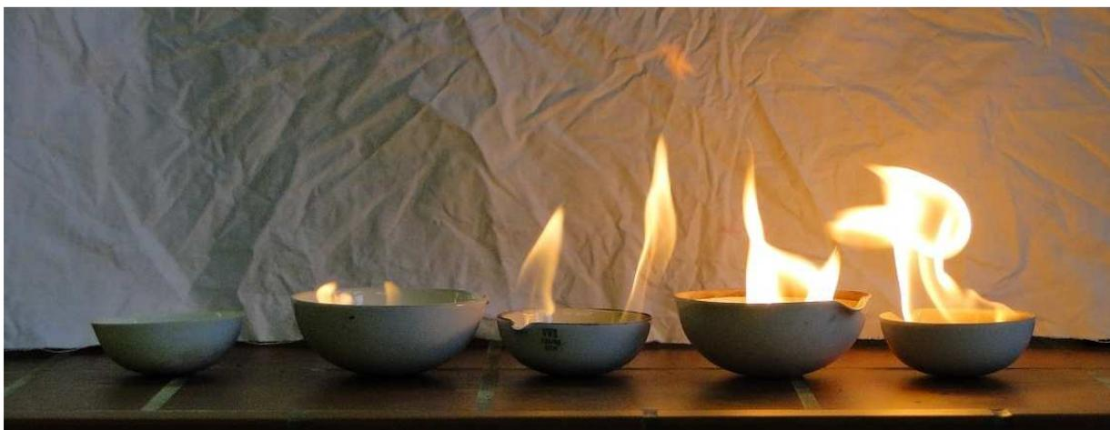
Abbildung 1: V.l.n.r.: Methanol, Ethanol, n-Propanol, n-Butanol, n-Pentanol.
