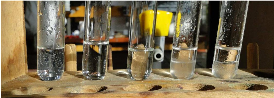
Abbildung 5: Verschiedene Alkohole mit Wasser. V.l.n.r.: Methanol, Ethanol, n-Propanol, n-Butanol, n-Pentanol.
