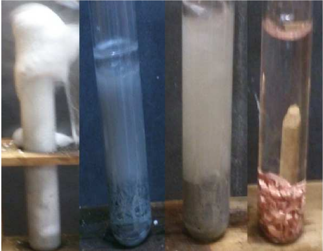
Abbildung 1: Reaktion von Metallen mit verd. Salzsäure. Von links nach rechts: Magnesium, Zink, Eisen, Kupfer.
