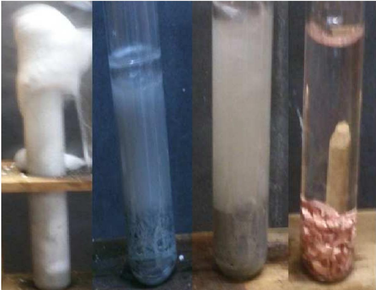
**Abbildung 4:** Reaktion von Metallen mit verd. Salzsäure. Von links nach rechts: Magnesium, Zink, Eisen, Kupfer.
