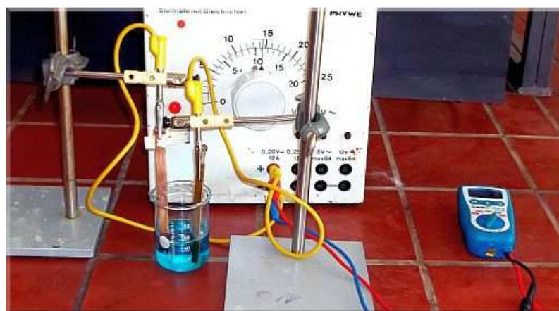
Abb. 1: Versuchsaufbau „Elektrolytische Kupferraffination“ links: Kupferelektrode, rechts Messingelektrode
