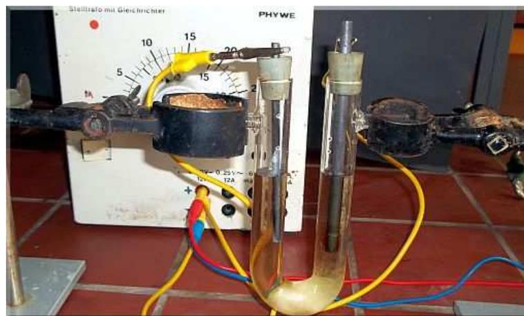
Abb. 8: Versuchsaufbau „Elektrolyse einer Zinkiodidlösung“
