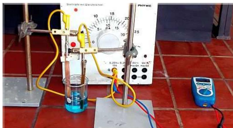
Abb. 1: Versuchsaufbau „Elektrolytische Kupferraffination“
