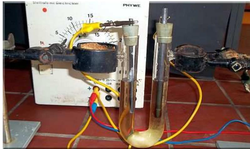
Abb. 6: Versuchsaufbau „Elektrolyse einer Zinkiodidlösung“
