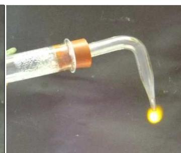
Abb 3: Darstellung (a) und Entzündung (b) von Methan
