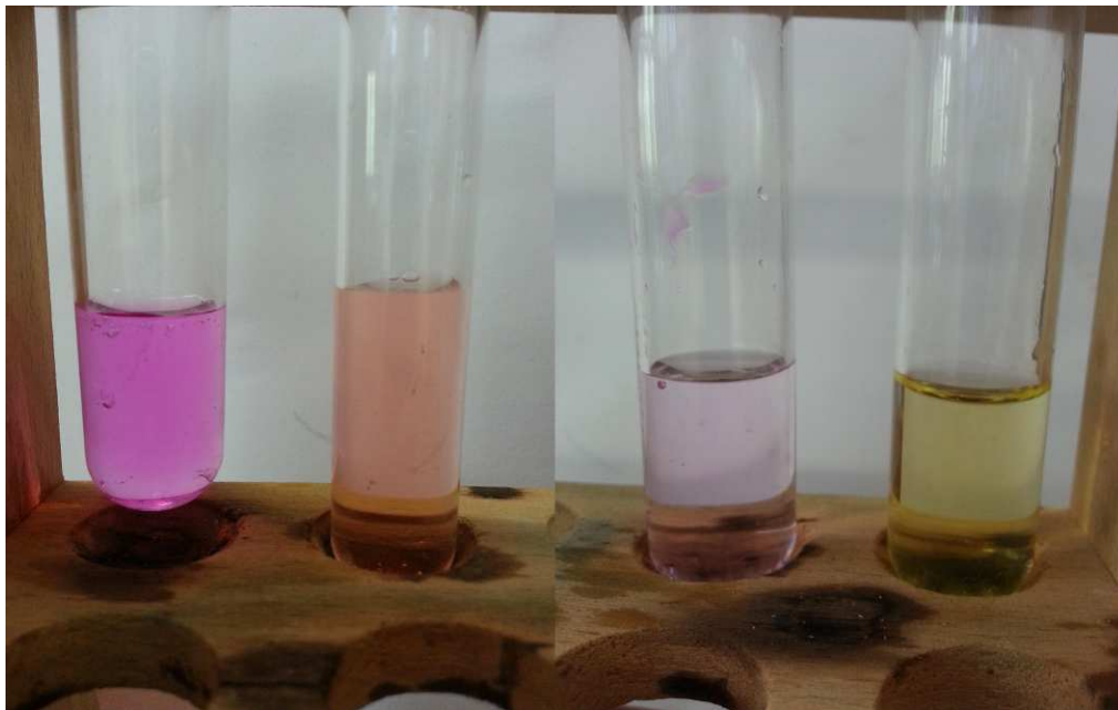
Abb. 1 - nach Zugabe von 1 Tropfen NaOH bzw. HCl: linkes Bild: dest. Wasser, rechts Bild: hartes Wasser
