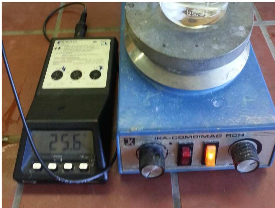
Abb. 7 - thermometrische Titration von Natronlauge mit Salzsäure-Lösung
