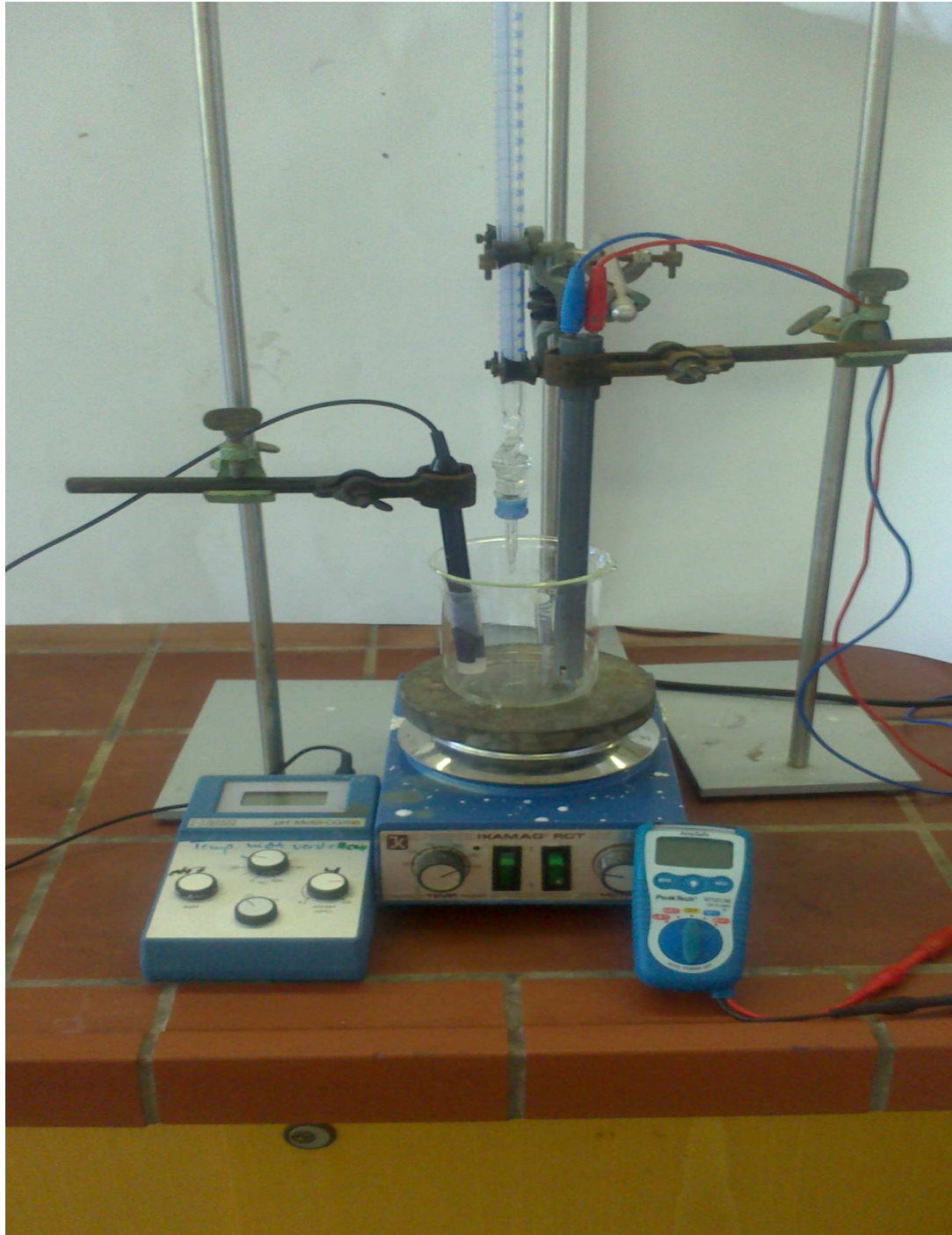
Abb. 5 – Links: pH-Meter ; Mitte: Becherglas mit HCl, Bürette mit NaOH; Rechts: Multimeter
