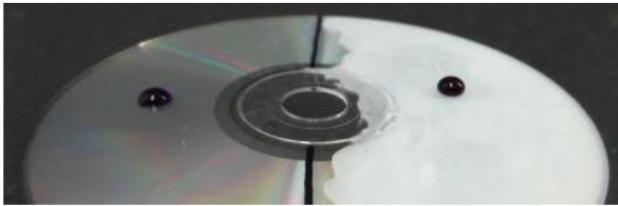
Abb. 5 – Lackmustropfen auf einer unbehandelten (links) und einer mit Aceton behandelten CD (rechts).
