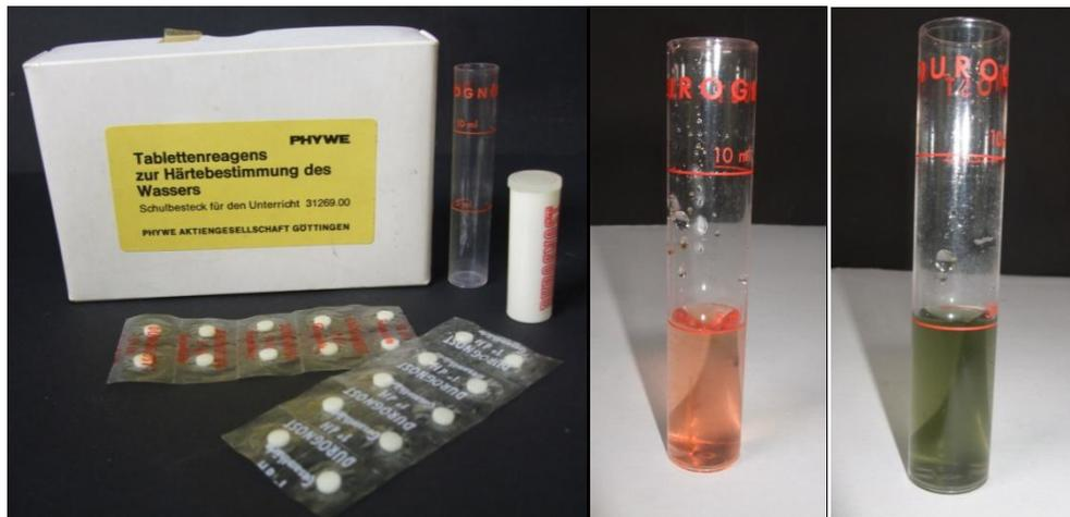
Abb. 7-9 – von links nach rechts: Phywe Testkasten, Probe mit Indikator vor Umschlag, Probe mit Indikator nach Umschlag.
