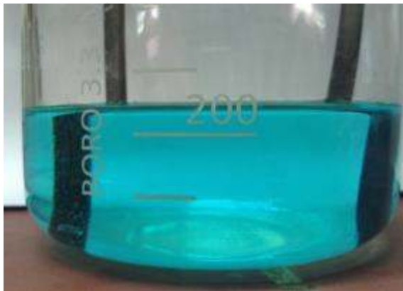
Abb. 1: Elektrolyse von Kupfer(II)-chlorid
