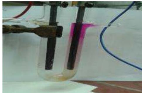
Abb. 2: Elektrolyse von Natriumchlorid
