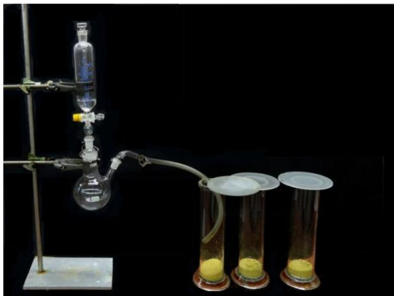
Abbildung 1: Der Versuchsaufbau für die Herstellung des Chlorgases.
