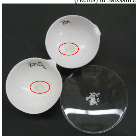
Abbildung 5: Der weiße, kristalline Rückstand der Lösungen von Zinkoxid (unten links) und Zink (oben rechts) in Salzsäure in den Porzellschalen. Auf dem Uhrglas das Salz Zinkchlorid zum Vergleich.
