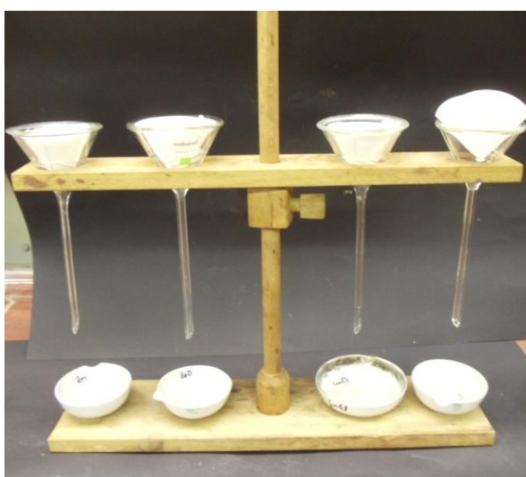
Abbildung 2: Der Versuchsaufbau für die Filtration.
