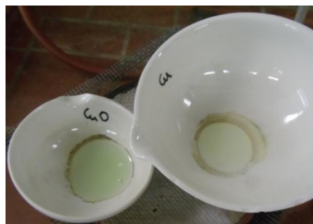
Abbildung 3: Die Lösungen von Kupfer (rechts) und Kupferoxid (links) in Salzsäure verfärben sich beim Eindampfen grün.
