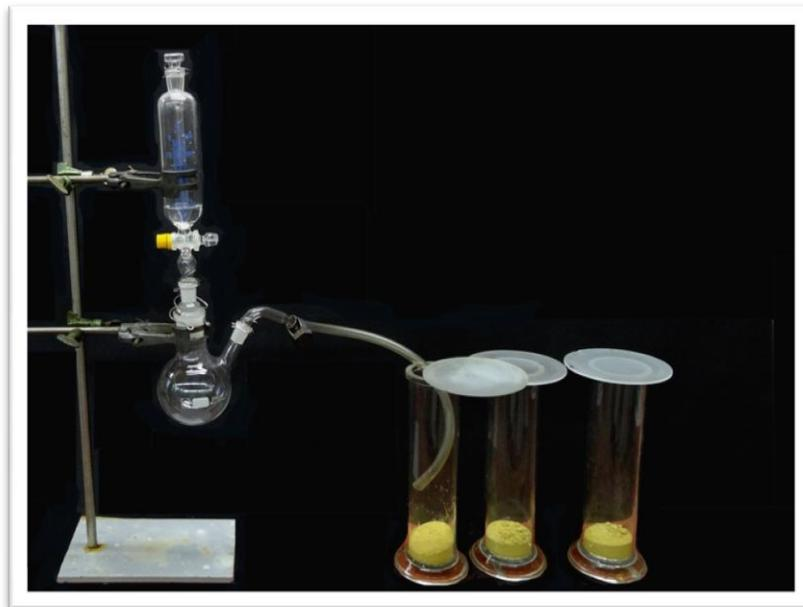
Abbildung 1: Versuchsaufbau der Gasentwicklungsapparatur
