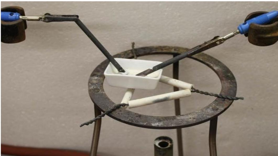
Abb. 1 - Versuchsaufbau der Schmelzflusselektrolyse.
