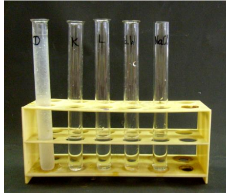
Abb. 4 - Deodorantlösung, Speisesalzlösung, Leitungswasser, demin. Wasser und Natriumchloridlösung vor Zugabe der Silbernitratlösung (von links nach rechts).
