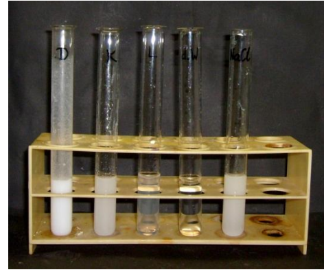
Abb. 5 - Deodorantlösung, Speisesalzlösung, Leitungswasser, demin. Wasser und Natriumchloridlösung nach Zugabe der Silbernitratlösung.
