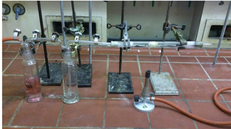
Abb. 1 - Versuchsapparatur zur Darstellung von Schwefelsäure nach dem Kontaktverfahren (Anmerkung: Die Apparatur müsste aus Gründen der Wahrnehmung eigentlich gespiegelt aufgebaut werden, dieser Aufbau war jedoch nicht möglich, da an der rechten Seite kein Vakuum gezogen werden konnte).
