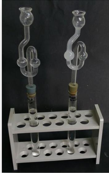
Abbildung 1: Das demin. Wasser mit dem Gärröhrchen mit Calciumhydroxid-Lösung (links) und das Reagenzglas mit Mineralwasser und einer getrübbten Calciumhydroxid-Lösung (rechts).
