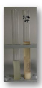
Abbildung 1: Entkalker und Ammoniumcitrat nach Zugabe von CaCl<sub>2</sub> und erhitzen (links) und Zitronensaft vor und nach Zugabe von CaCl<sub>2</sub> und Erhitzen (rechts).
