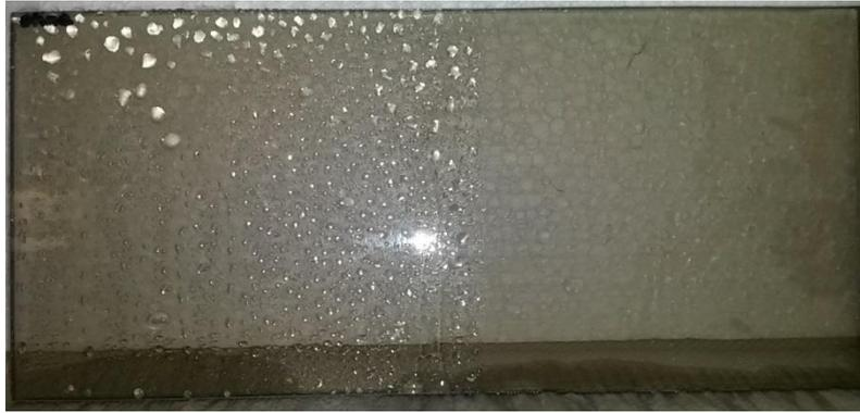
Abb. 1- links unbehandelte Seite und rechts mit TTIP-Lösung behandelte Seite.
