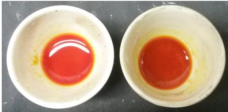
Abb. 1 – links Blindprobe und rechts indirekter Nachweis von Titandioxid nach Zugabe von Wasserstoffperoxid-Lösung.
