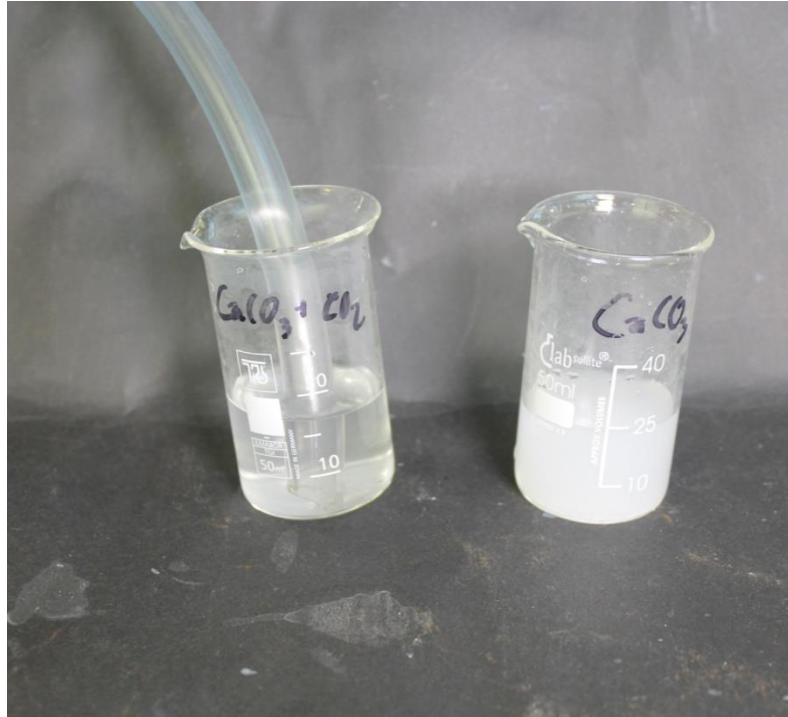
Abb. 3 - Einleiten von Kohlenstoffdioxid in Calciumcarbonatlösung.
