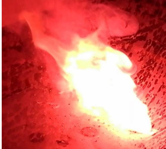
Abb. 1: Bengalisches Feuer, Reaktionsgemisch brennt mit hellroter Flamme
