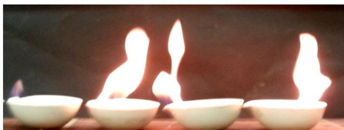
Abbildung 5 – V.l.n.r.: Methanol, Ethanol, n-Propanol, n-Butanol, n-Pentanol.
