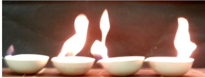
Abbildung 5 – V.l.n.r.: Methanol, Ethanol, n-Propanol, n-Butanol, n-Pentanol.
