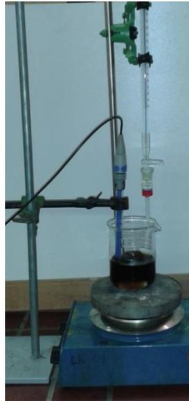
Abbildung 3: Darstellung des Versuchsaufbaus der Titration von Cola.
