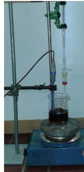
Abbildung: Versuchsaufbau zur Cola-Titration.
