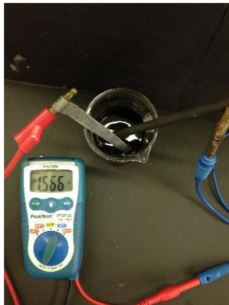
Abb. 1- Zink und Graphit-Elektroden in der Zink-Kohle-Batterie mit einem Multimeter.
