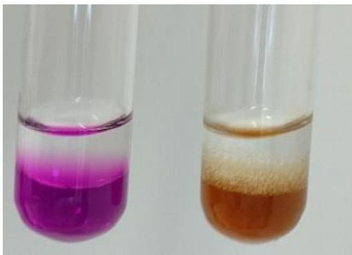
Abbildung 1: Ergebnis links mit Cyclohexan, rechts mit Cyclohexen
