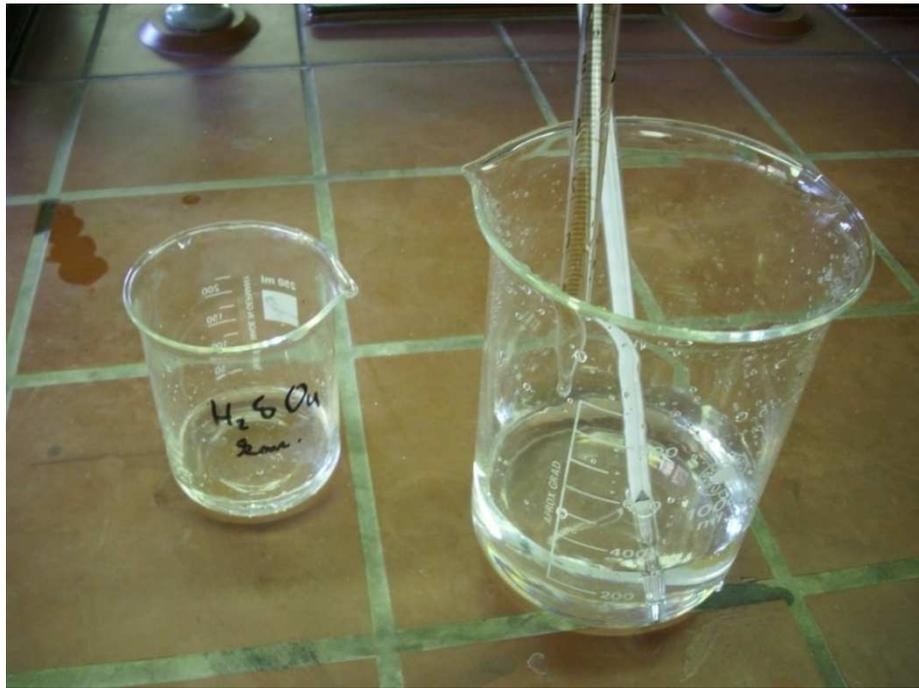
Abbildung 3: Versuchsaufbau "Schwefelsäure verdünnen"
