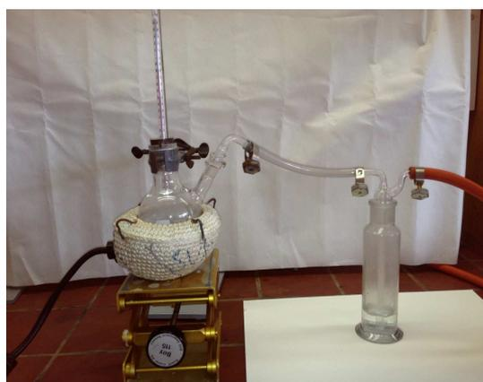
Abbildung 4: Entfärbung von Bromwasser
