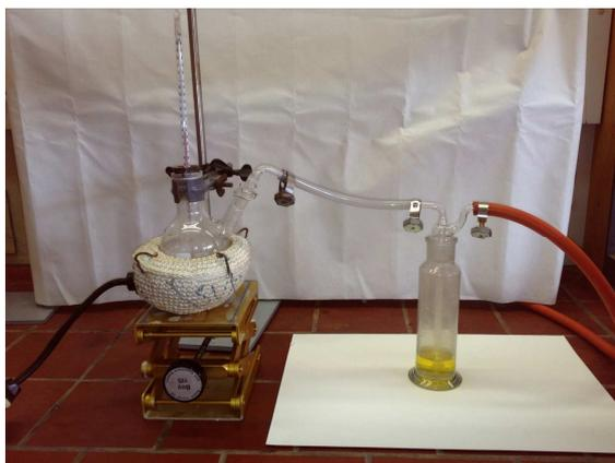
Abbildung 3: Darstellung von Ethen aus Ethanol und Schwefelsäure
