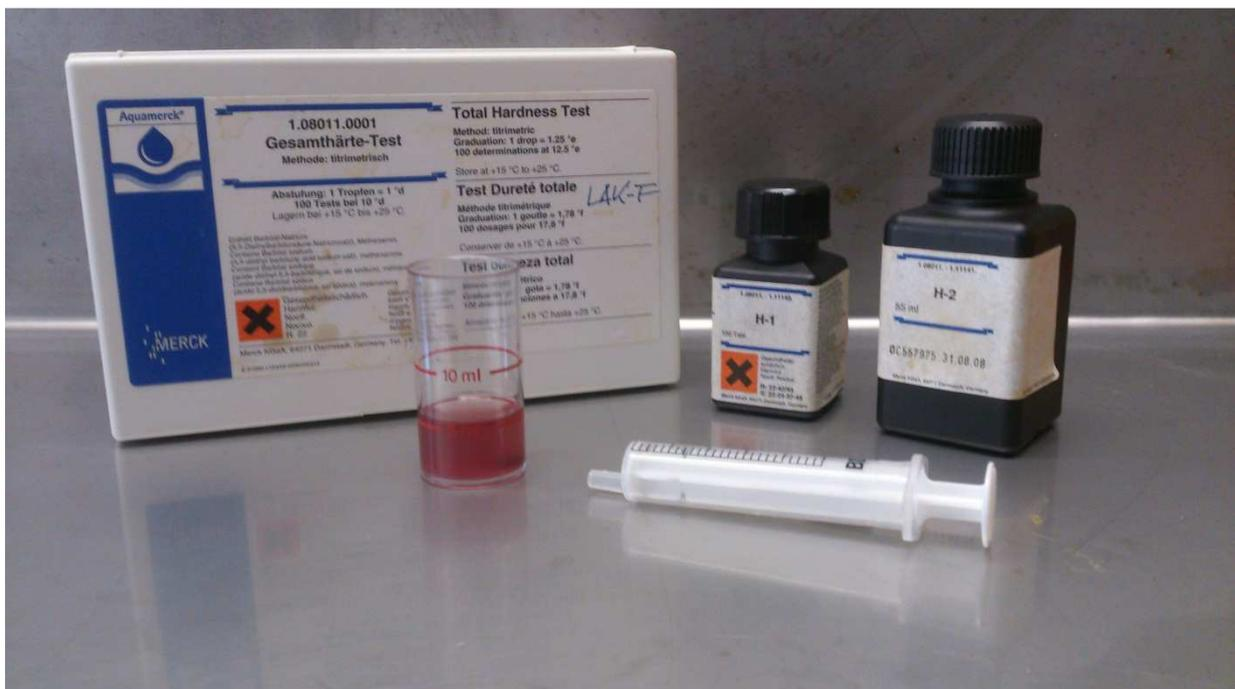
Abb. 7 - Testkit für den Gesamthärte-Test
