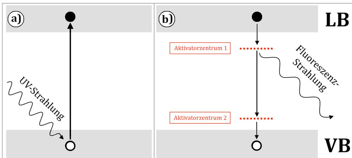
Abb. 2 – Modell zur Fluoreszenz von halbleitenden Zinkoxid-Nanopartikeln; a) Anregung eines Elektrons aus dem Valenzband (VB) in das Leitungsband (LB) mit UV-Licht. b) Rekombination unter Emission von Fluoreszenz-Strahlung, verändert nach<sup>[3]</sup>.
